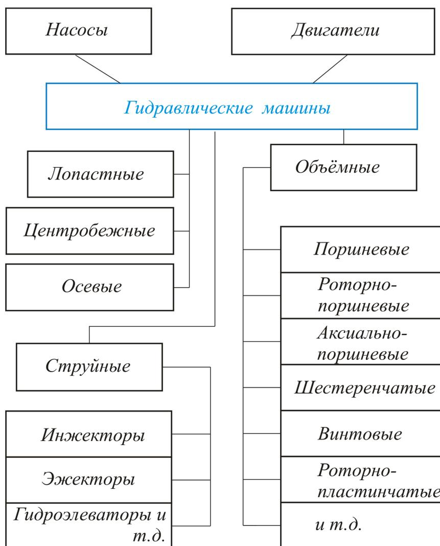
Рис.58. Примерная классификация гидравлических машин
